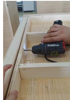
9. Pričvrstite stropnu ploču vijcima na gornji dio bočnih ploča
