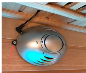
1. Namestite generator kisikovih ionov
